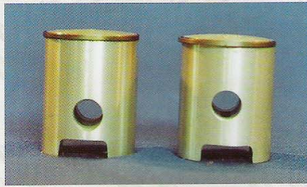
▲ Kolben mit unterschiedlicher Kompressionshöhe zur Anpassung der abweichenden Pleuellänge.
