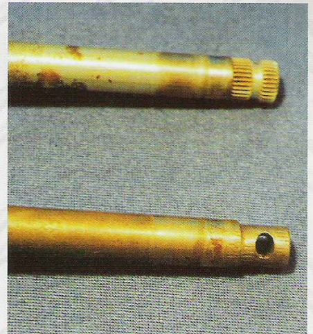
Verzahnung der Schaltwelle: Neuteil und ein verschlissenes, unsachgemäß repariertes Exemplar.
